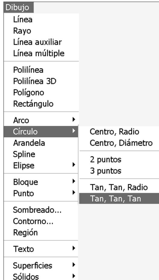
Ahora el programa está preparado para dibujar una circunferencia tangente a tres elementos; por tanto, en el área de comandos se nos pide el primer elemento al que tiene que ser tangente la circunferencia. Señalaremos la recta con el cursor. Seguidamente nos pide el segundo elemento y señalaremos una de las dos circunferencias. Por último, señalaremos la última circunferencia y el programa trazará la circunferencia tangente a los tres elementos.
